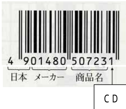
図1 JANコードとそのしくみ
